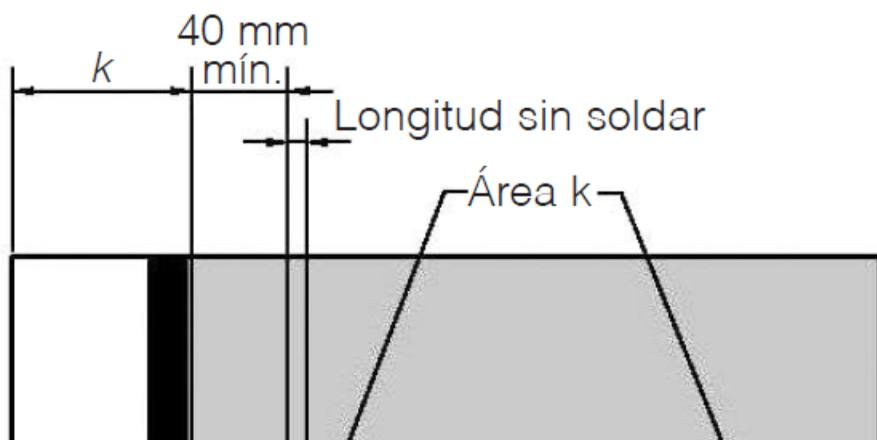
**Figura 10.2. Longitud de contacto reducida entre el rigidizador y el alma y las alas de la sección, producto del corte de esquina.**
