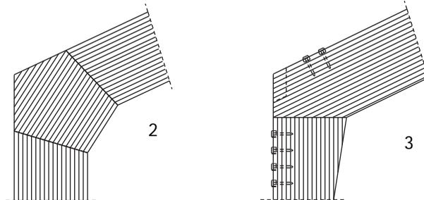
Figura 2. Recomendaciones de conexiones rígidas (adaptadas de la referencia 21).
