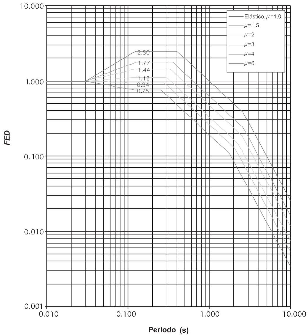
**FIGURA 5.1. Factor espectral dinámico,  $FED$ , para sitios de cimentación tipo  $S_1$  en zona sísmica II (amortiguamiento  $z = 5\%$ ; ductilidades  $m = 1, 1.5, 2, 3, 4, 6$ ).**
