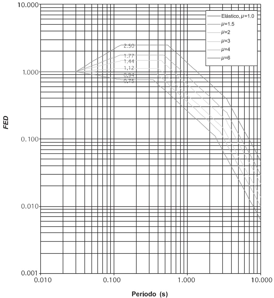
**FIGURA 5.2. Factor espectral dinámico,  $FED$ , para sitios de cimentación tipo  $S_2$  en zona sísmica II (amortiguamiento  $z = 5\%$ ; ductilidades  $m = 1, 1.5, 2, 3, 4, 6$ ).**
