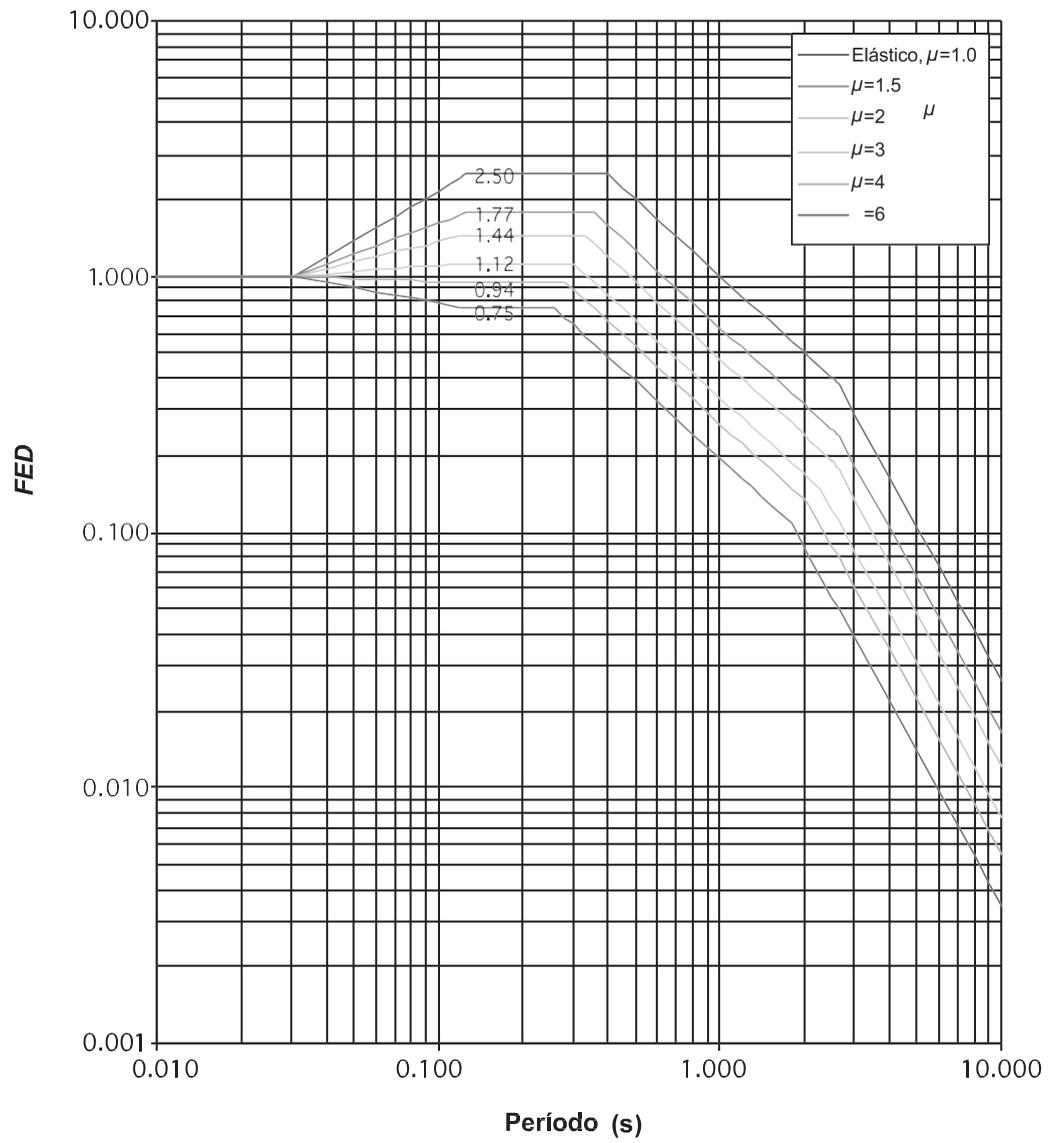
**FIGURA 5.9. Factor espectral dinámico,  $FED$ , para sitios de cimentación tipo  $S_1$  en zona sísmica IV (amortiguamiento  $z = 5\%$ ; ductilidades  $m = 1, 1.5, 2, 3, 4, 6$ ).**
