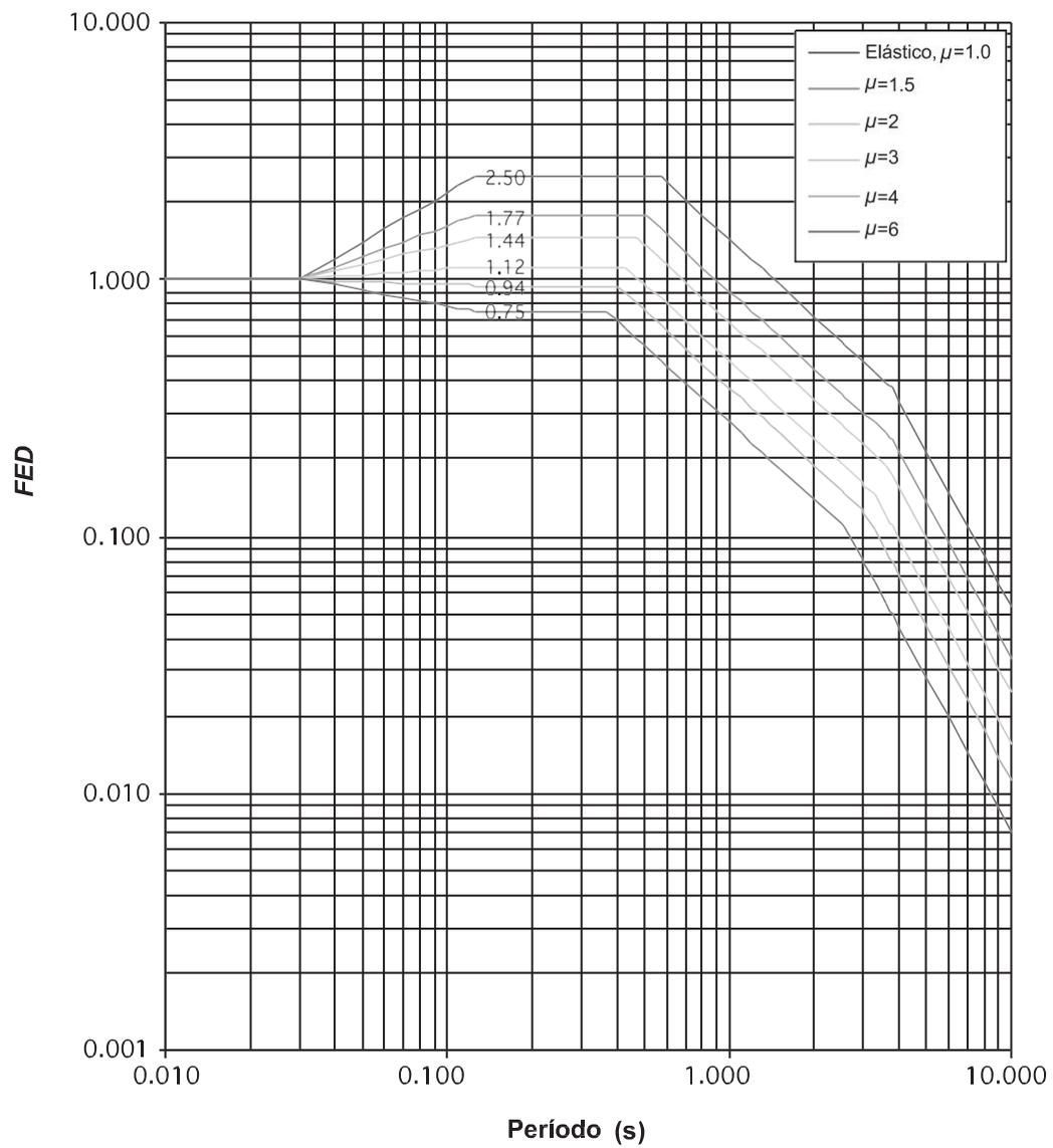
**FIGURA 5.3. Factor espectral dinámico,  $FED$ , para sitios de cimentación tipo  $S_3$  en zona sísmica II (amortiguamiento  $z = 5\%$ ; ductilidades  $m = 1, 1.5, 2, 3, 4, 6$ ).**
