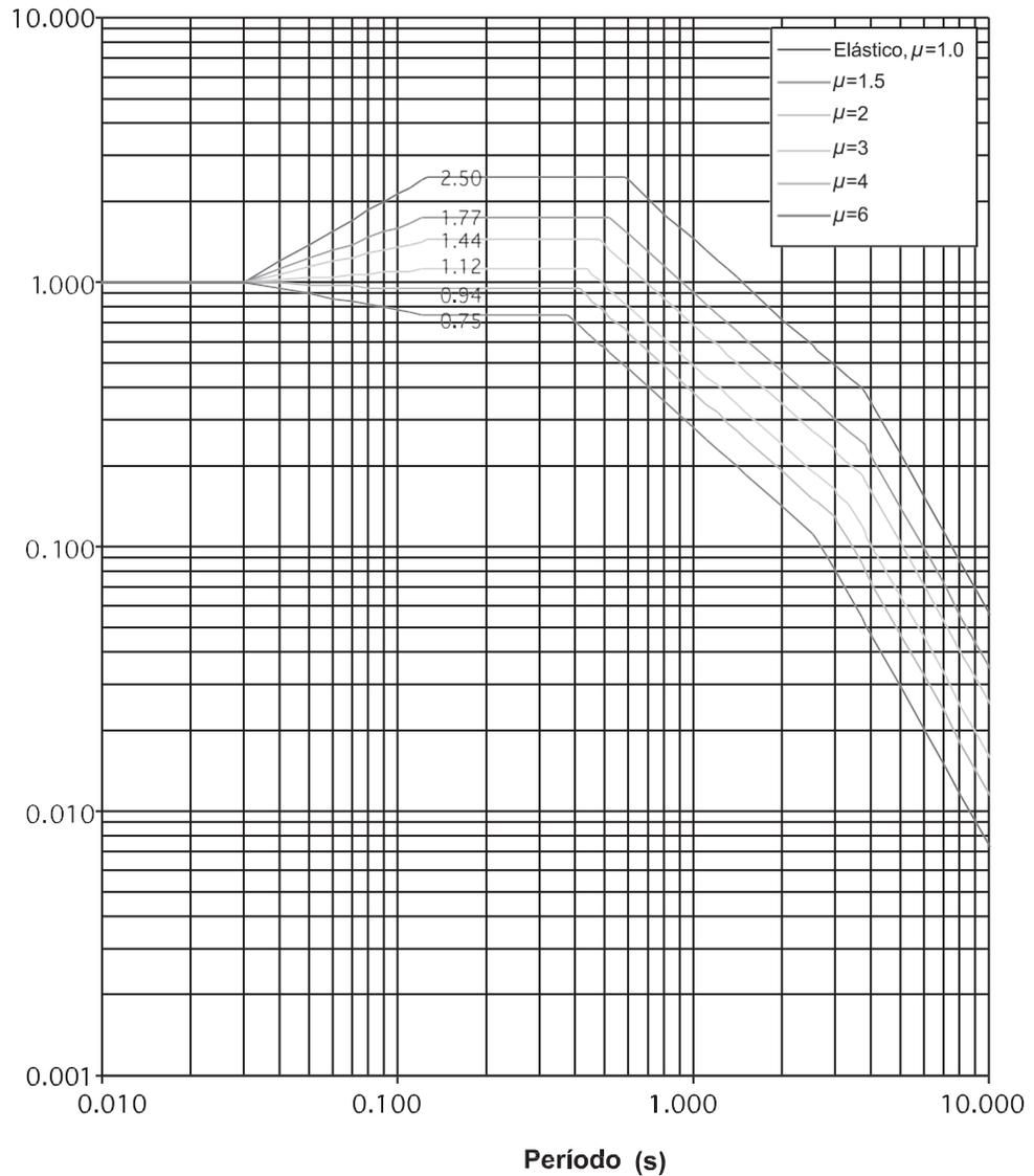
**FIGURA 5.11. Factor espectral dinámico,  $FED$ , para sitios de cimentación tipo  $S_3$  en zona sísmica IV (amortiguamiento  $z = 5\%$ ; ductilidades  $m = 1, 1.5, 2, 3, 4, 6$ ).**
