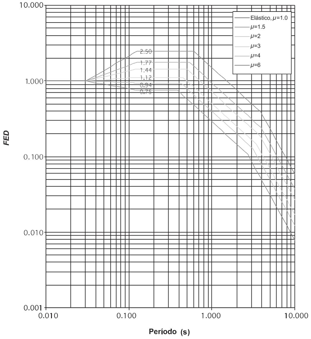
**FIGURA 5.7. Factor espectral dinámico,  $FED$ , para sitios de cimentación tipo  $S_3$  en zona sísmica III (amortiguamiento  $z = 5\%$ ; ductilidades  $m = 1, 1.5, 2, 3, 4, 6$ ).**
