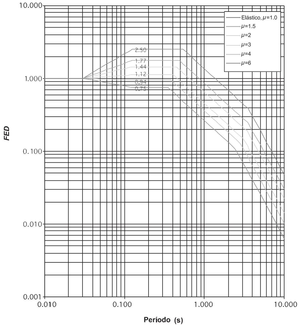
**FIGURA 5.6. Factor espectral dinámico,  $FED$ , para sitios de cimentación tipo  $S_2$  en zona sísmica III (amortiguamiento  $z = 5\%$ ; ductilidades  $m = 1, 1.5, 2, 3, 4, 6$ ).**
