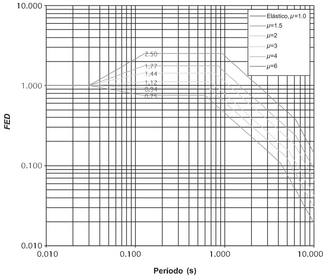
**FIGURA 5.8. Factor espectral dinámico,  $FED$ , para sitios de cimentación tipo  $S_4$  en zona sísmica III (amortiguamiento  $z = 5\%$ ; ductilidades  $m = 1, 1.5, 2, 3, 4, 6$ ).**
