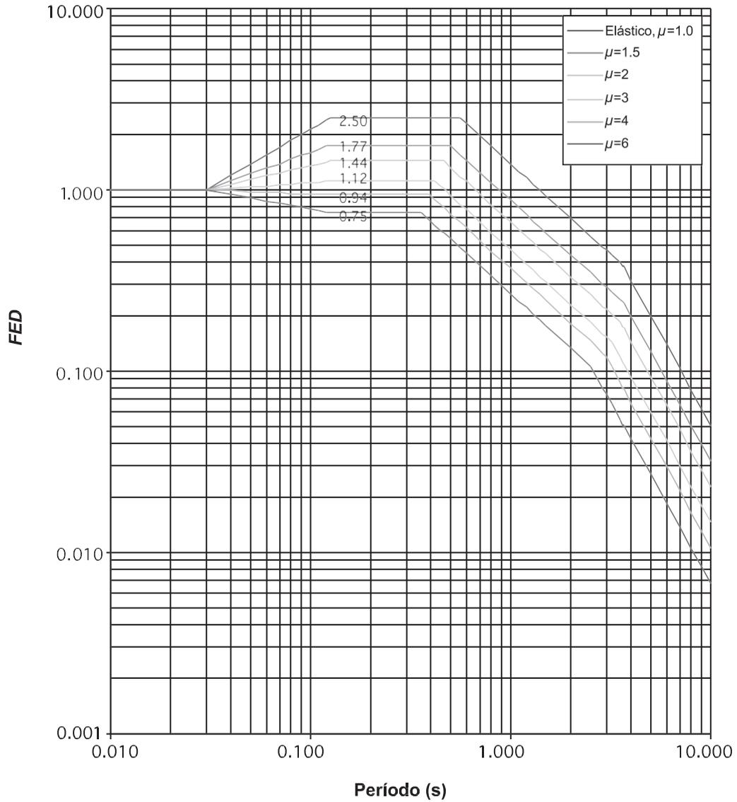
**FIGURA 5.10. Factor espectral dinámico,  $FED$ , para sitios de cimentación tipo  $S_2$  en zona sísmica IV (amortiguamiento  $\zeta = 5\%$ ; ductilidades  $m = 1, 1.5, 2, 3, 4, 6$ ).**
