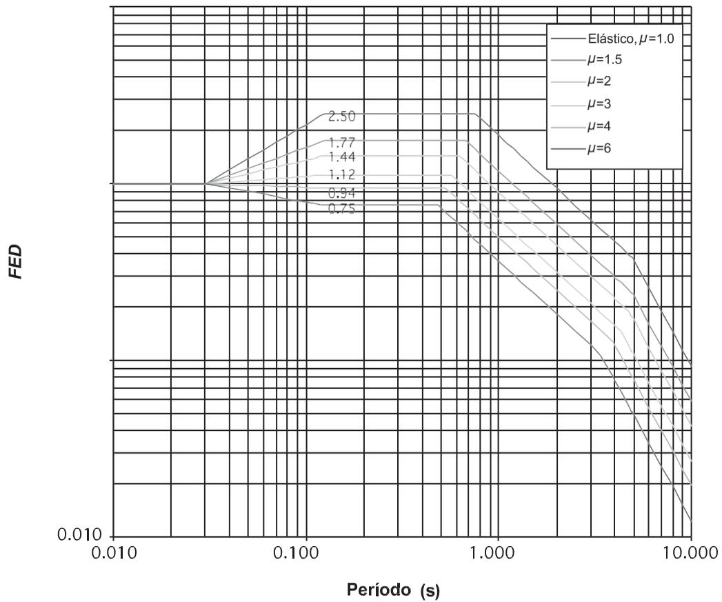
**FIGURA 5.4. Factor espectral dinámico,  $FED$ , para sitios de cimentación tipo  $S_4$  en zona sísmica II (amortiguamiento  $z = 5\%$ ; ductilidades  $m = 1, 1.5, 2, 3, 4, 6$ ).**
