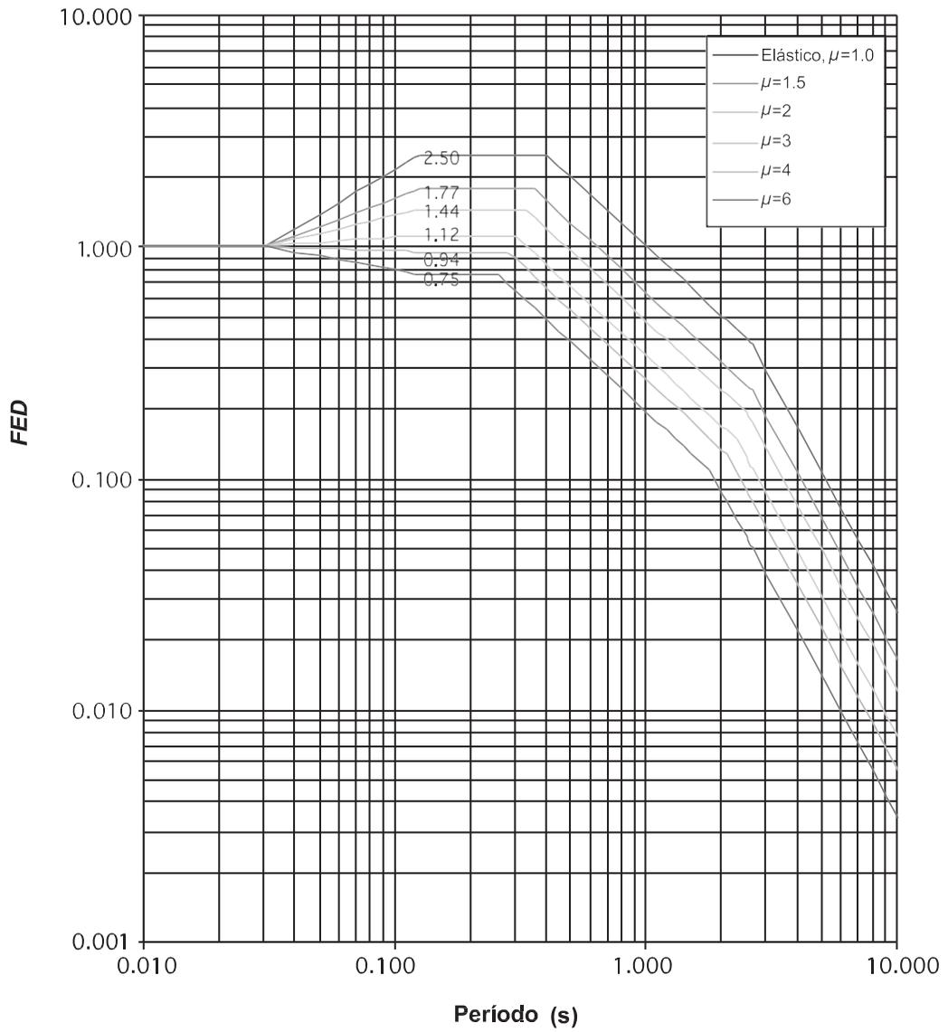
**FIGURA 5.5. Factor espectral dinámico,  $FED$ , para sitios de cimentación tipo  $S_1$  en zona sísmica III (amortiguamiento  $z = 5\%$ ; ductilidades  $m = 1, 1.5, 2, 3, 4, 6$ ).**
