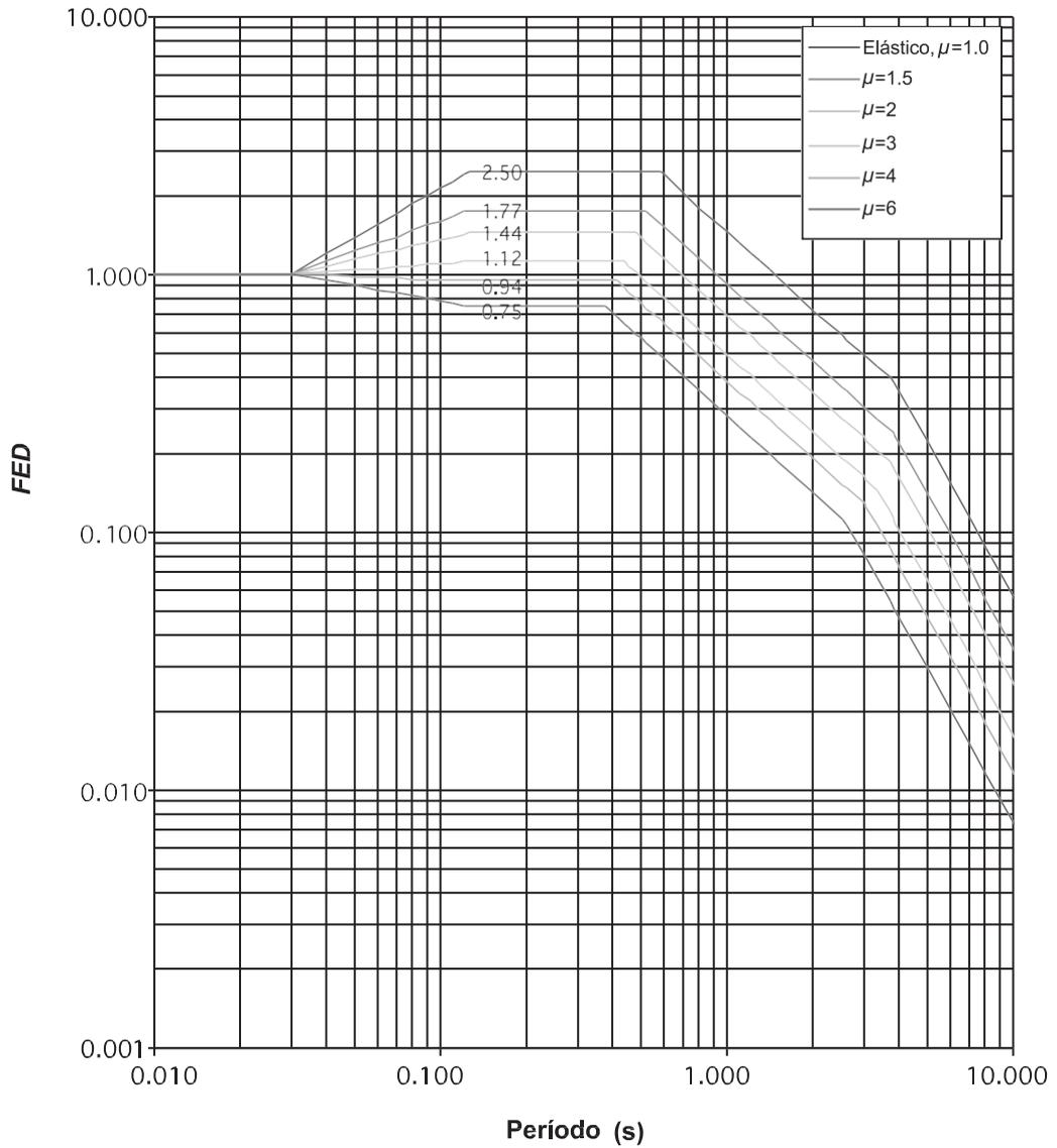
**FIGURA 5.11. Factor espectral dinámico,  $FED$ , para sitios de cimentación tipo  $S_3$  en zona sísmica IV (amortiguamiento  $z = 5\%$ ; ductilidades  $m = 1, 1.5, 2, 3, 4, 6$ ).**
